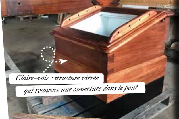
Claire-voie : structure vitrée qui recouvre une ouverture dans le pont
